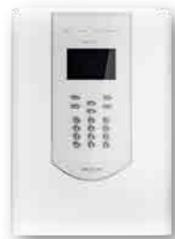
Die Funk-Zentrale ist das Gehirn der Anlage. Sie kommuniziert per Funk mit bis zu 148 Komponenten. Die Übertragung ist über das bidirektionale DynaBand®-Verfahren mit automatischem Frequenzwechsel gesichert. Zusätzlich erfolgt alle 300 Sekunden eine Funkstreckenüberprüfung. Eine 12-Stunden-Notstromversorgung garantiert den sicheren Betrieb.
